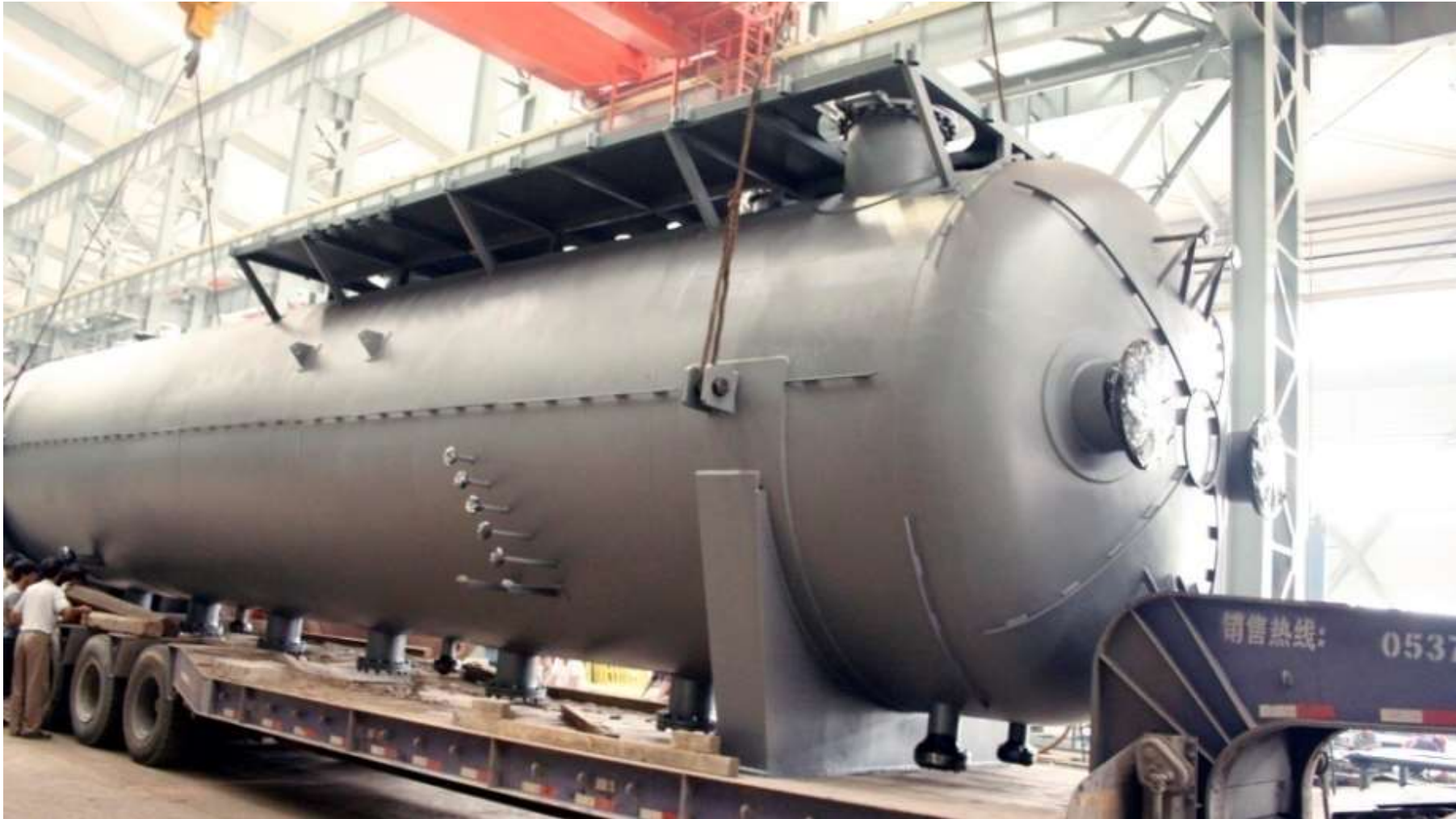
China Oil HBP Group Сепаратор для нефти и газа \Phi 3000 \times 14000 \times L12
