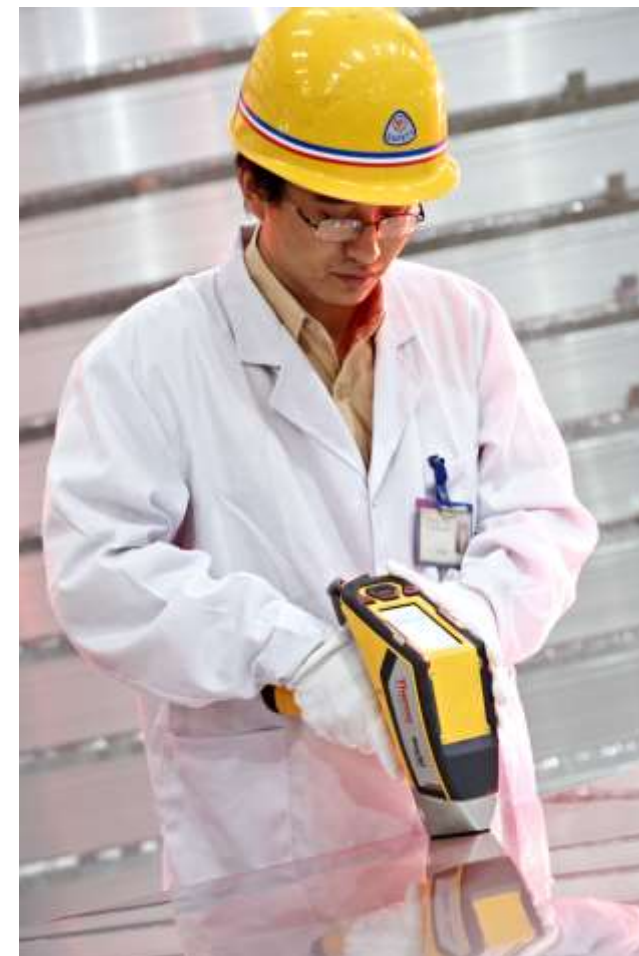
Ручной прибор для спектрального анализа материала
