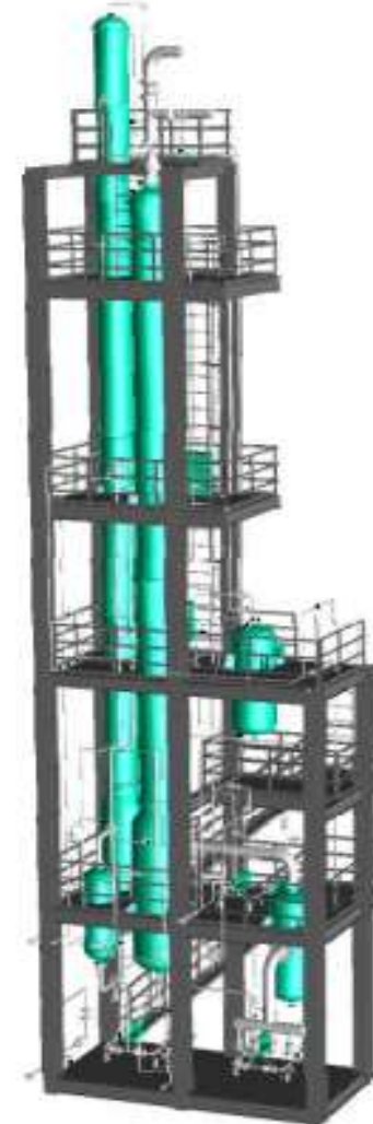
Установка для регенерации ацетонового растворителя Система рекуперации ЛОС) (Qilu Antibiotics Pharmaceutical Co., Ltd.)
